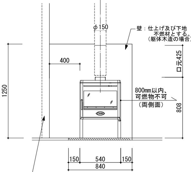
※本体の左右に壁がある場合、壁を不燃仕上げにして左右400mm以上離隔距離を確保して下さい。
