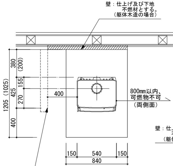
※本体の左右に壁がある場合、壁を不燃仕上げにして左右400mm以上離隔距離を確保して下さい。
